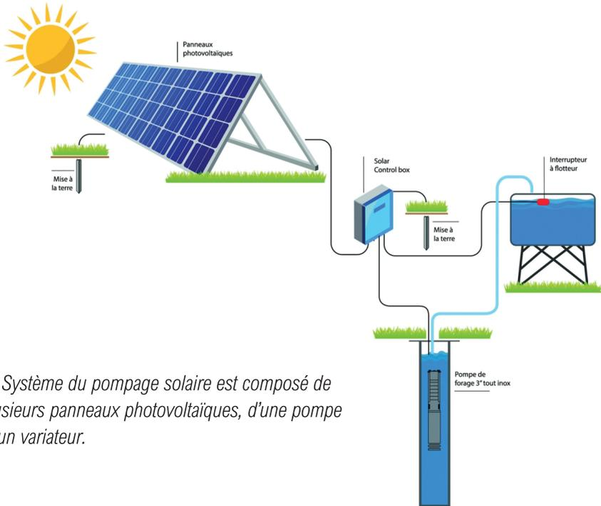
*Le Système du pompage solaire est composé de plusieurs panneaux photovoltaïques, d'une pompe et un variateur.*
